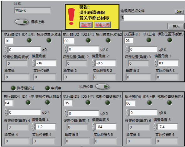
图 6 前面板关节运动控制部分截图
