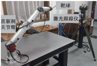
图 10 标定实验 Fig. 10 Calibration experiment
