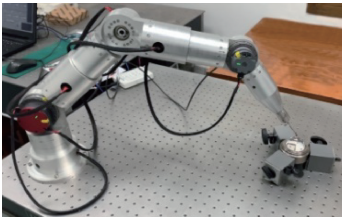
图 12 标准球测量实验 Fig. 12 Standard spherical measurement experiment
