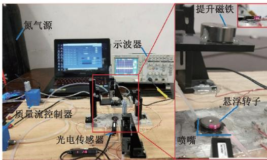
图 13 混合悬浮结构实验平台
