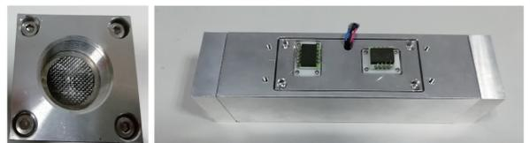
图 5 PPD 层流流量传感器实物
