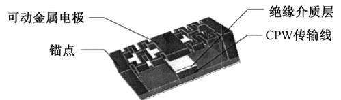
图 1 弯曲型悬臂梁 RF-MEMS 开关
