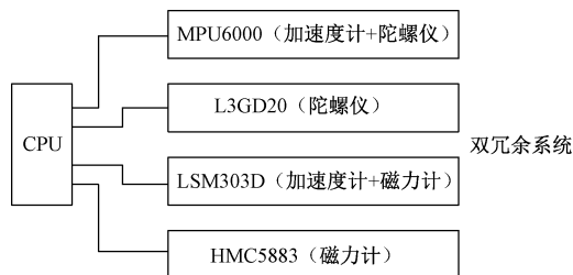
图 1 飞控系统多传感器冗余硬件组成
