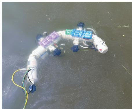
图 9 USM 的 C 构型示意图
