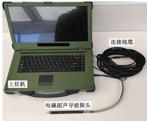
图2 电磁超声导波检测模块
