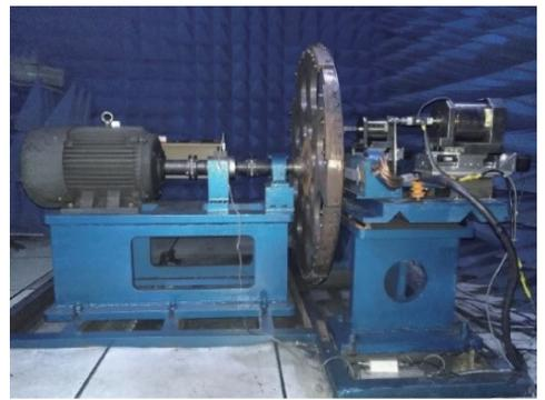
图 1 滑动电接触试验机
