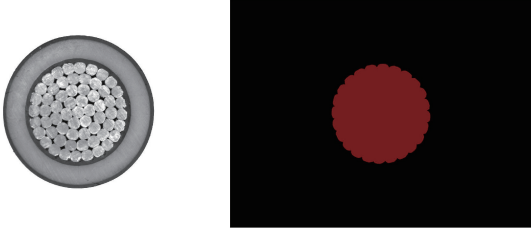
图 13 绝缘层分割数据集示例样本
