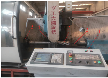
1-控制面板;2-顶尖;3-螺杆转子;4-盘铣刀;5-卡盘 图 1 LKX-300G 螺杆专用铣床 Fig.1 LKX-300G special screw milling machine
