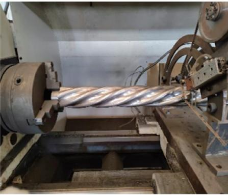
图 4 螺杆磨削现场示意图
