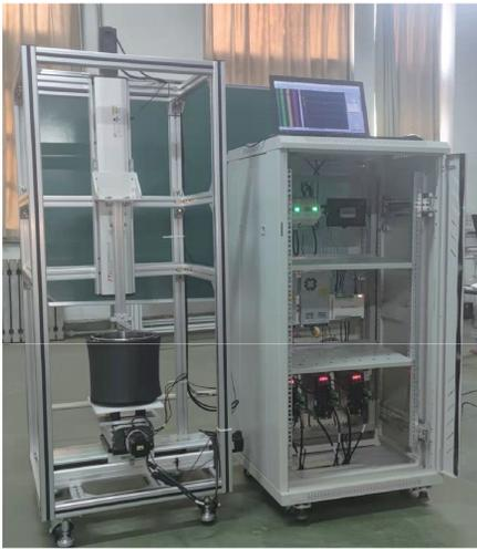
图4 高温超导磁悬浮力三维测量系统。
