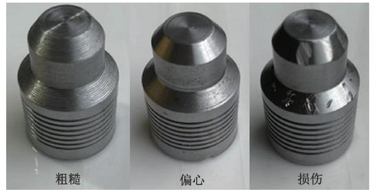
图 1 实验故障单向阀阀芯
