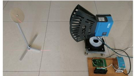
图 9 目标尺寸测量实验装置
