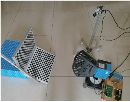
图 6 雷达坐标系定位实验装置
