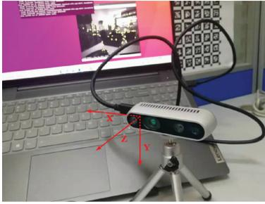
图 11 相机坐标系示意图
