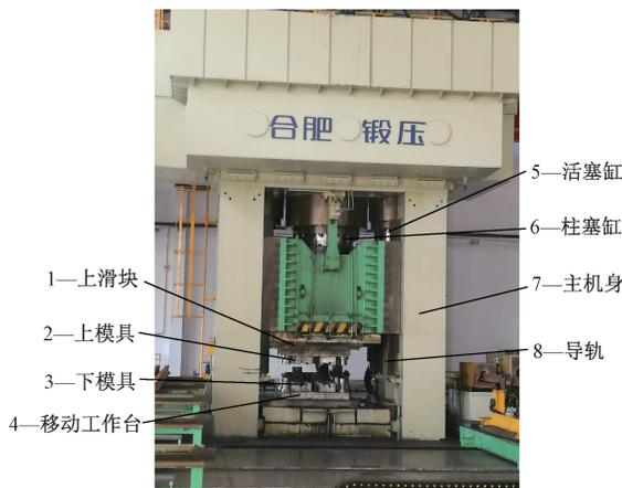
图 9 道岔成型热模锻压机
