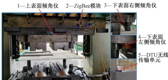
图 10 滑块检测实验图
