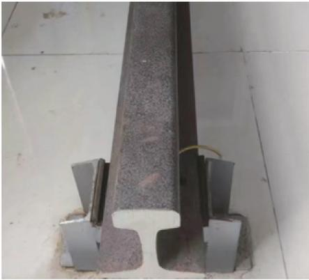
图7 室内未经磨损的50 kg/m的标准钢轨模型
