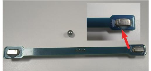
图 9 新型感应线圈测速靶
