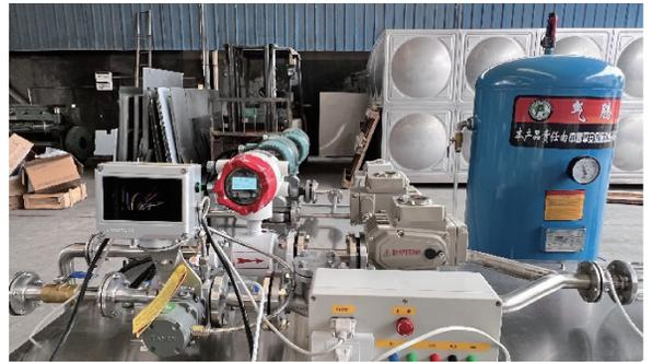
图 14 水流量实验装置实物图
