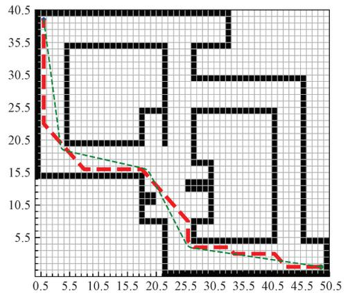
图 18 两种算法在室内地图环境中生成的路径对比
