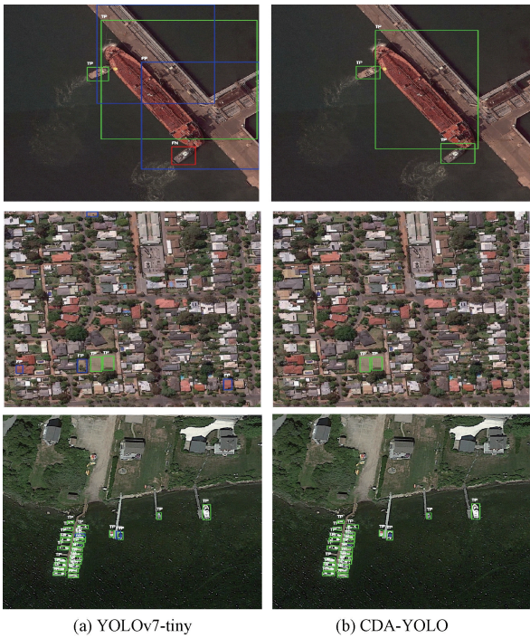
图 7 YOLOv7-tiny 与 CDA-YOLO 方法在多尺度区域(上)、复杂背景区域(中)和小目标密集区域(下)检测结果
