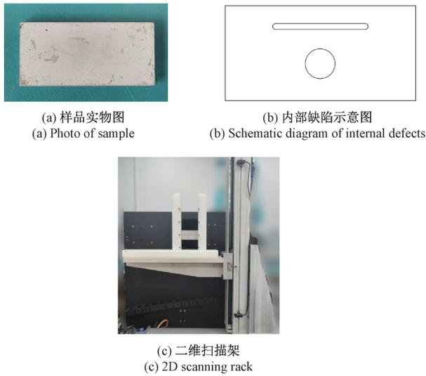
图 8 样品实物、内部缺陷示意图与二维扫描架
