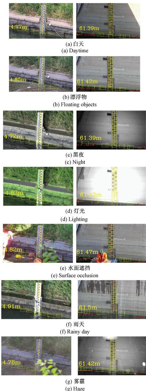
图 14 YOLOv5 水位识别实例图
