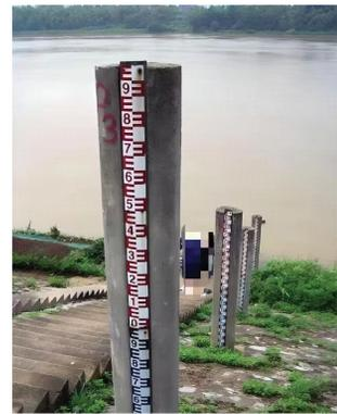
图 3 水尺图像示意图
