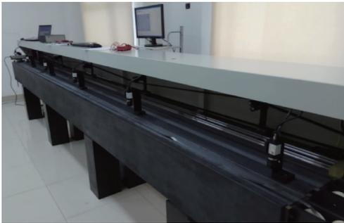
图 8 线纹尺检定装置
