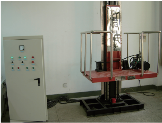
图9 绕组分段 PMLSM 直驱提升系统实验平台 Fig.9 Experimental platform of segment PMLSM
