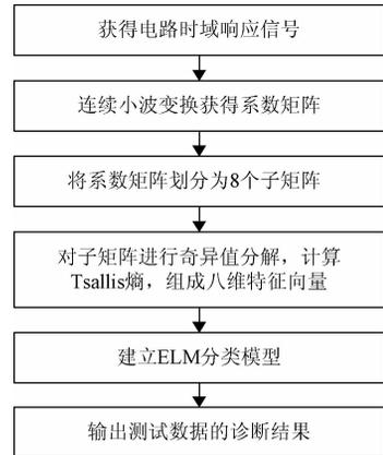
图 2 故障诊断流程
