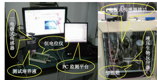
图10 生物反应器智能化监测系统实物
