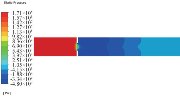
图 10 孔板流量计  $P_0$  轴向平面的压力云图
