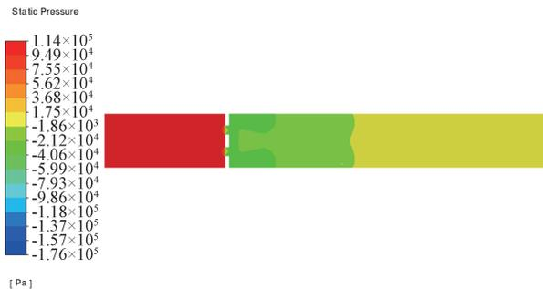
图 12 孔板流量计  $P_4$  轴向平面的压力云图
