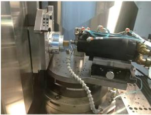
图 1 微透镜阵列模具加工
