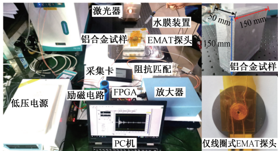
图 15 激光-仅线圈式 EMAT 的检测系统实验平台、铝合金试样及仅线圈式 EMAT 探头实物图
