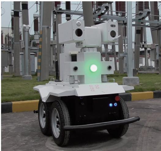
图 13 电力巡检机器人
