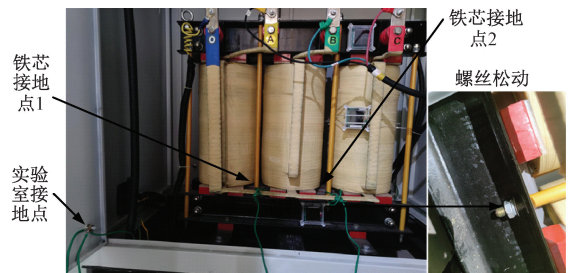
图 9 干式变压器的故障模拟
