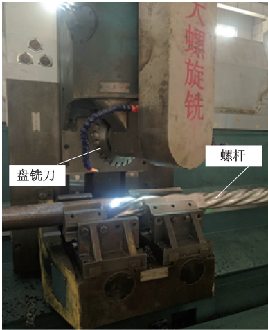
图 2 五头螺杆转子加工现场
