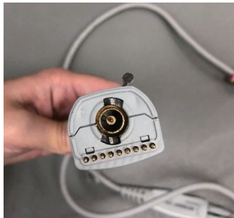
图 3 Keysight Infiniimax 1169A 型号探头放大器接口 Fig. 3 Keysight Infiniimax 1169A probe amplifier interface
