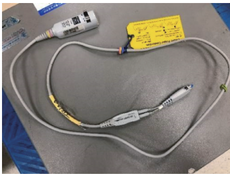
图 2 Keysight Infiniimax 高频差分有源探头系统
