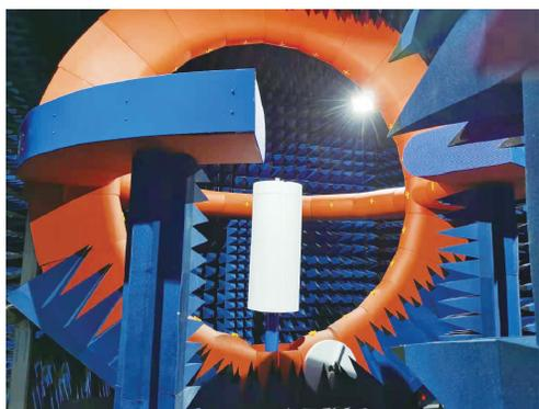
图 10 天线在微波暗室中测试图
