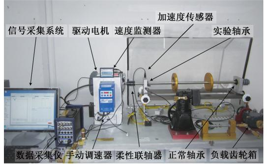
图 6 MFS-MG 试验台
