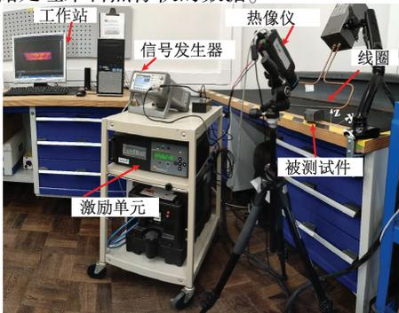
图 3 涡流脉冲热像系统
