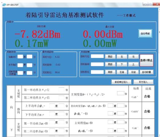
图 4 着陆引导雷达角基准测试软件界面
