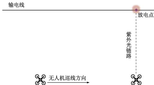
图1 无人机巡线紫外放电检测
