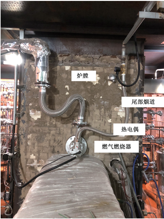
图 6 燃烧实验装置
