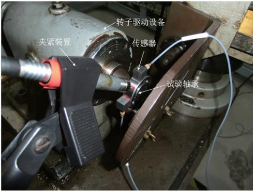
图 2 轴承故障实验设备安装图
