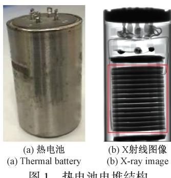
图 1 热电池电堆结构
