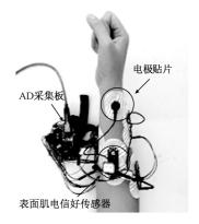
图 5 表面肌电传感器佩戴方式 Fig. 5 Wearing of sEMG sensors
