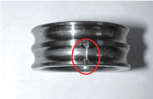
图 3 轴承内圈故障 Fig. 3 Inner ring defect
