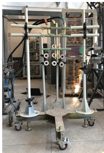
图 9 低压带电作业电弧试验平台
