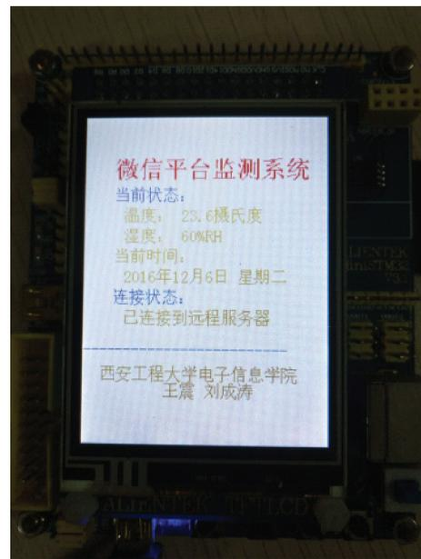
图10 LCD显示屏显示的温湿度信息
