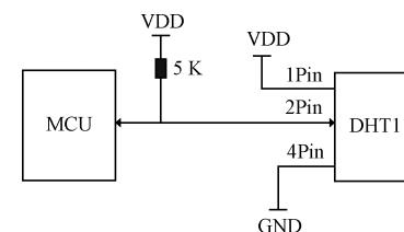
图2 温湿度DHT11模块与MCU的典型连接
