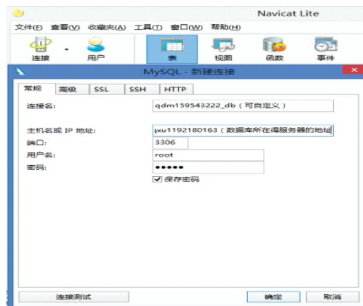
图 5 Navicat 与阿里云服务器的数据库连接
