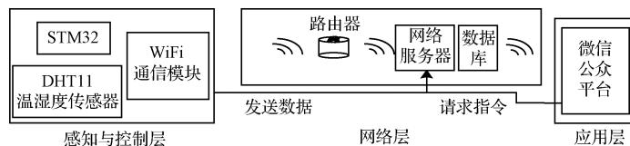
图1 系统构架
