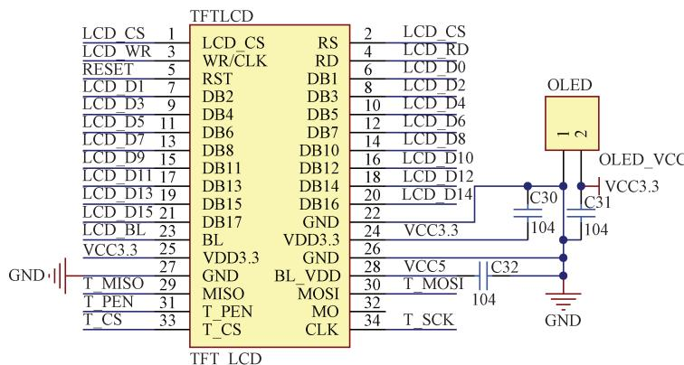
图 4 液晶显示模块原理
