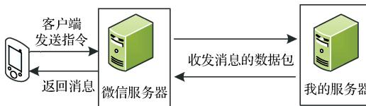
图 7 阿里服务器、微信和客户端消息收发原理
