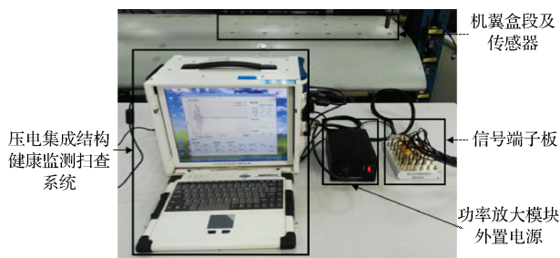
图8 导波结构健康监测系统实物连接图
