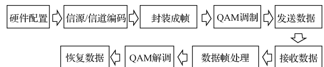
图 9 无线通信系统实现流程
