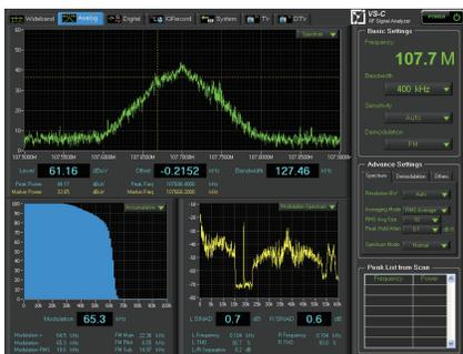
图6 V-5421信号测量分析软件
